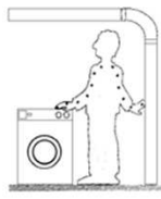
Fig. 5 - Percorso della corrente
