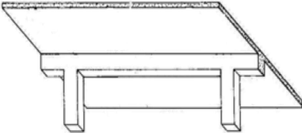
Solaio di c.a. a **travetti prefabbricati**
