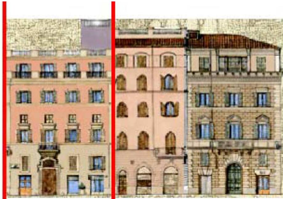
**AGGREGATO STRUTTURALE** = insieme di edifici **non** omogenei, a contatto o con un collegamento più o meno efficace, che possono interagire in caso di azione sismica
