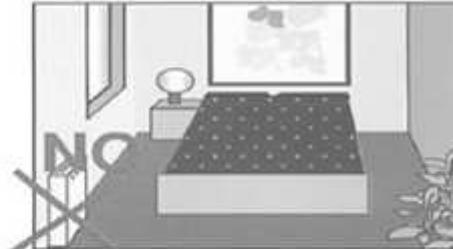
Gli apparecchi di tipo "B" per la produzione di acqua calda sanitaria, muniti di tubo di scarico dei prodotti della combustione non possono essere installati nelle camere da letto; è consentita la loro ubicazione nei locali uso bagno o doccia purché il volume degli stessi sia almeno di 1,5 m<sup>3</sup> per ogni kW di portata termica installata e comunque non minore di 20 m<sup>3</sup>.
