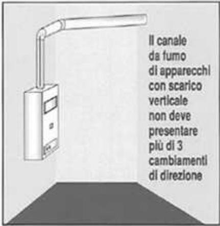
**Il canale da fumo di apparecchi con scarico verticale non deve presentare più di 3 cambiamenti di direzione**
