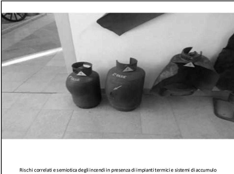
Nel serbatoio N 1 viene rappresentato il tipico rigonfiamento da surriscaldamento esterno, il gas liquefatto all'interno viene riscaldato per irraggiamento esterno, vaporizzando aumenta di volume comprimendosi nella parte superiore del serbatoio. Il repentino raffreddamento ed allontanamento dalla fonte di calore ne hanno impedito la rottura.
