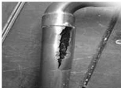
Le immagini sono eloquenti: Non si tratta di un tubo di ferro o qualche altro materiale; ma di rame un metallo già di per se "nobile" con caratteristiche meccaniche e di ossidazione superiori ad altri metalli, non si tratta di una caldaia installata secoli fa; ma di una **caldaia installata 3 anni fa**.
