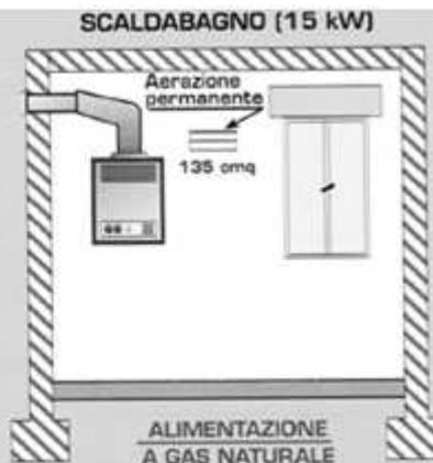
Calcolo della superficie di ventilazione del locale (situato nella parte alta della parete esterna)
