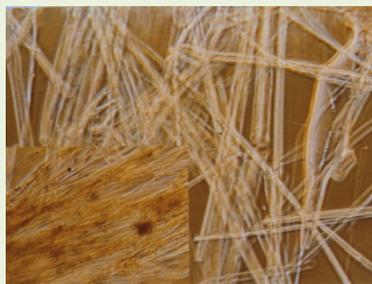
Campione 3: Visione Microscopica a 100X in contrasto di fase di vari fasci di fibre di lana di vetro. Nel particolare allo stesso ingrandimento un aggregato della maglia di contenimento.
